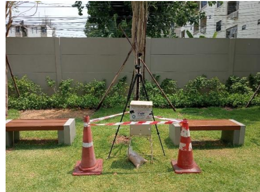
รูปที่ 78 ติดตั้งเครื่องตรวจวัดคุณภาพสิ่งแวดล้อม (คุณภาพอากาศ ระดับเสียง และความสั่นสะเทือน)
