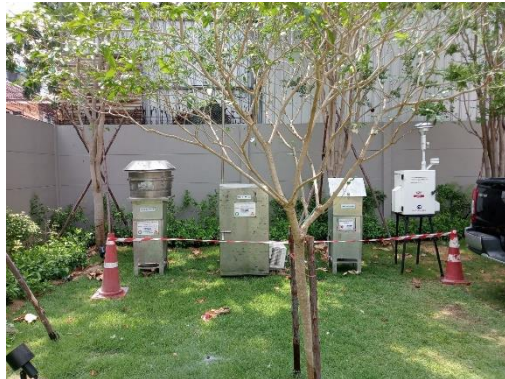
รูปที่ 78 ติดตั้งเครื่องตรวจวัดคุณภาพสิ่งแวดล้อม (คุณภาพอากาศ ระดับเสียง และความสั่นสะเทือน)
